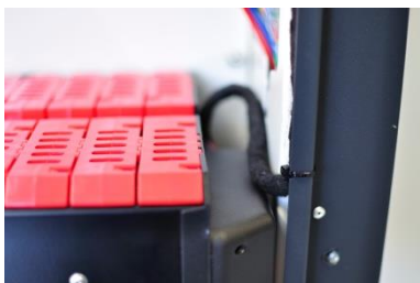
Obrázek 22 - poloha kabelů při zasouvání baterie
