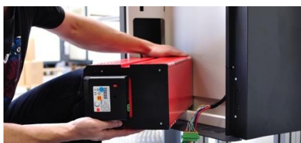
Obrázek 17 – montáž první baterie
